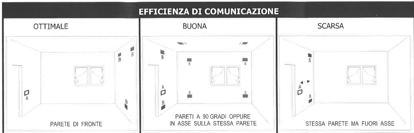
A = Dispositivo di comando      B = Dispositivo ricevitore
