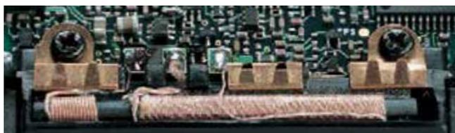
Antenna in ferrite interna per ricezione onde medie e onde corte senza problemi
